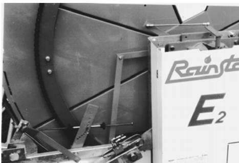
...über das Regelgestänge die direkt auf der Turbine sitzende Regelnocke betätigt wird, und somit die Turbinendrehzahl nachregelt.
