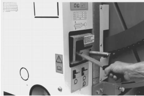
Getriebeschalthebel in Stellung „PE-Rohrauszug“ bringen. Der Schalthebel wird durch eine Feder nach oben gedrückt und verrastet.
