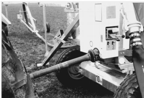
Das PE-Rohr kann bei Bedarf auch mit dem Traktor über eine Gelenkwelle aufgespelt werden.
