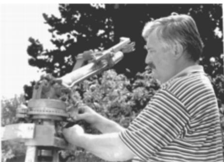
Beim Weitstrahlregner den Sektor einstellen (ca. 220° für volle Streifenbreite). Weitere Hinweise siehe eigene Betriebsanleitung für den Regner. Der WINDGUN kann durch Verstellen des Strahlerhebungswinkels auf die vorherrschenden Windverhältnisse abgestimmt werden.
