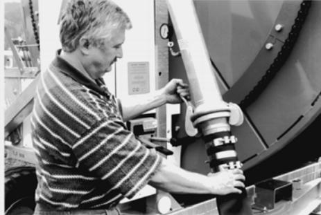
Den Druckschlauch ankuppeln. Die Wasserzufuhr öffnen.
