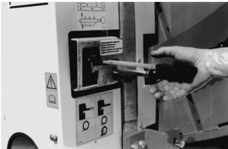
2. Abschalthebel in die Abschaltstellung ziehen und durch langsames, vorsichtiges nach unten ...
