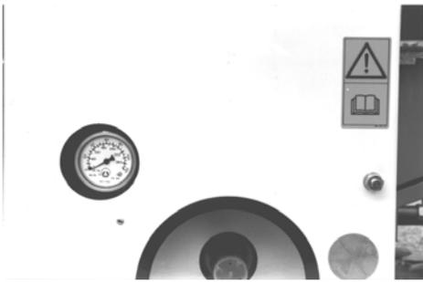
Die Einzugsgeschwindigkeit des Regnerstatives ist am Tachometer ablesbar.
