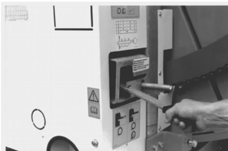
Der Abschalthebel muß in Stellung „PE - Rohrauszug“ gebracht werden.
