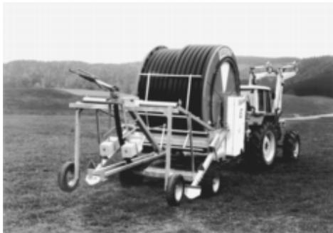
Beim Transport soll die Haspel in Fahrtrichtung gedreht und mit dem Vorstecker gesichert sein. Das Stativ, der Deichselstützfuß sowie die beiden hinteren Gerätestützen müssen hochgehoben bzw. eingefahren sein. Den Rainstar bei seitlichem PE-Rohrabzug am Feldrand rechtwinkelig zum vorgesehenen Beregnungstreifen abstellen und vom Traktor abhängen.
