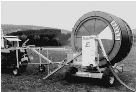
Bei Verwendung eines Kufenstatives wird das Stativ hochgehoben. Das standardmäßige Radstativ oder Radstativ asymm. muß nicht hochgehoben werden.
